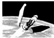
H-IIロケット:その大切な衛星を打ち上げる前線な環境から守るフェアリンクは川崎重工が製造しています。
